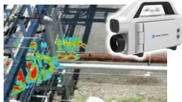
ガス漏洩位置・流量の即時計測
