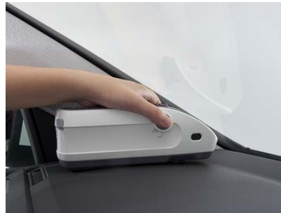
フロントウインドウ下方のパネル部も測定を容易に (CM-25cG)
